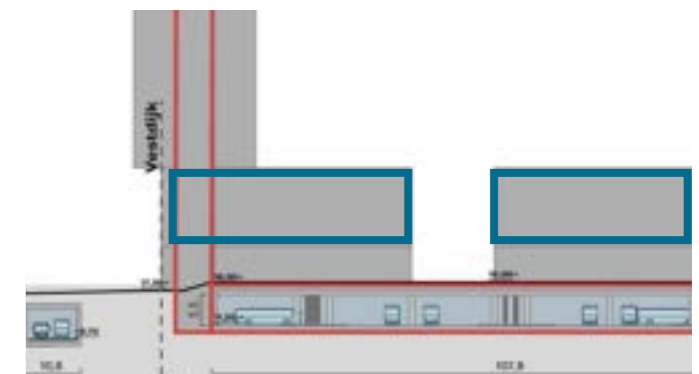
Doorsnede vastgoedoptie met kernen naast het busstation
