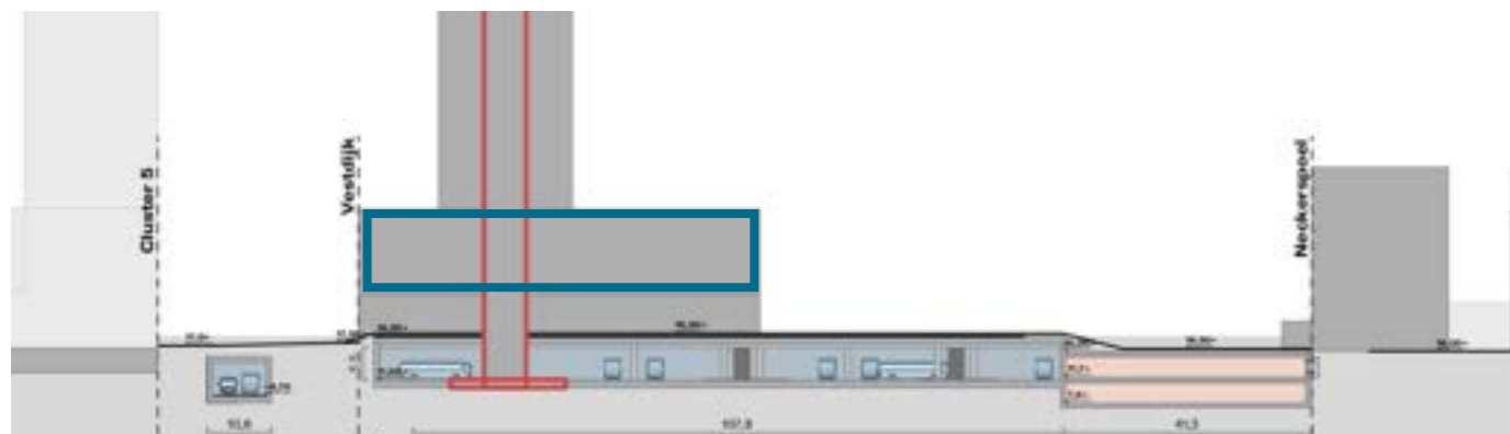
Doorsnede optie vastgoed met kernen door het busstation heen
