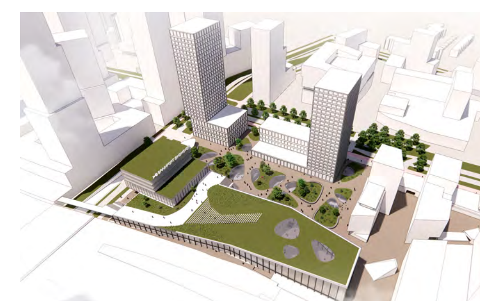
Ondergronds busstation met haakse stationshal
